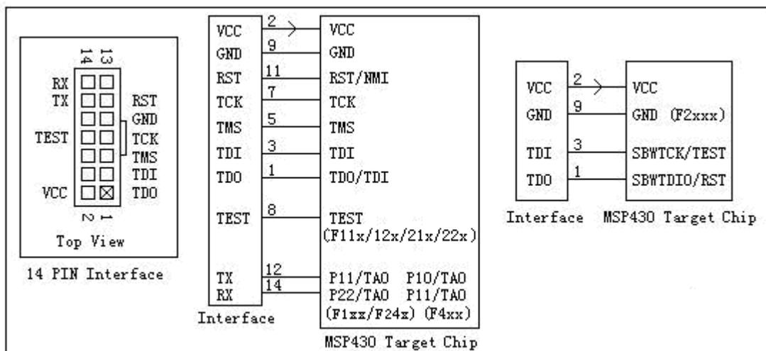
图 5. 编程器接口连接图
